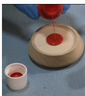
Pouring base coat
